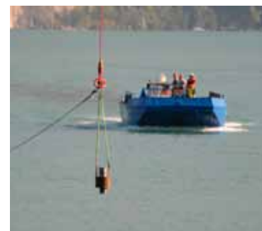
Helikopter mit dem notwendigen Unterlastgewicht von 400 kg.
