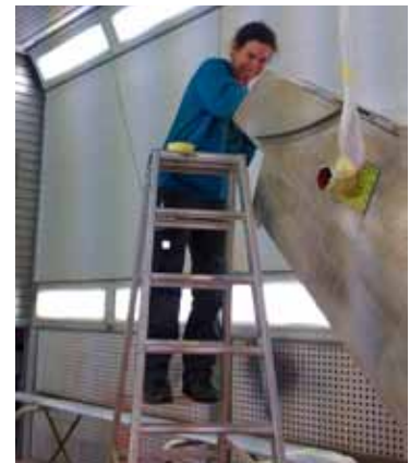
Vorbereitung zur Heckgrundierung
